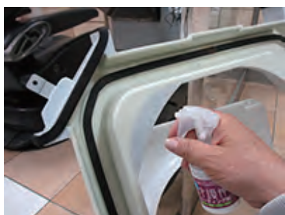
内部パネルのコーティング
